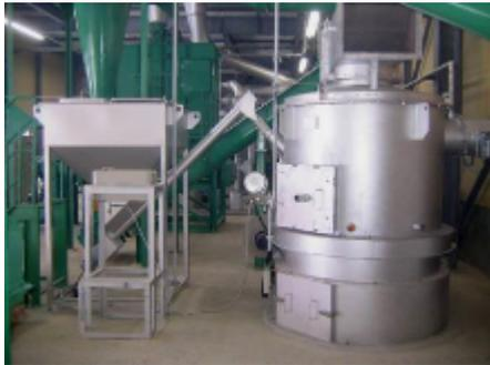
・1パストライヤー専用ペレット焚焼炉
