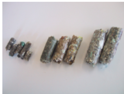
φ8 φ16 φ20 ダイ孔径大きさにより、ペレットの大きさを変更する事ができます
