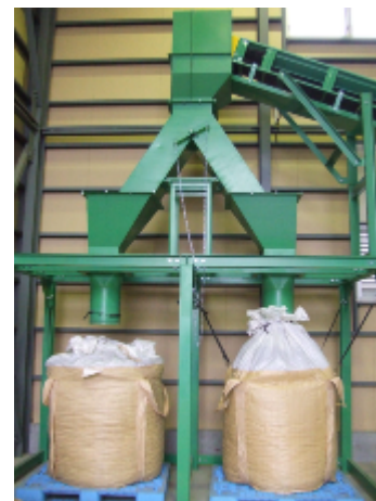
フレコンバック詰装置 RPFをフレコンバック詰めします。
