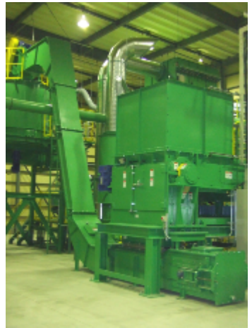
破碎機 原料を粗破碎します。
