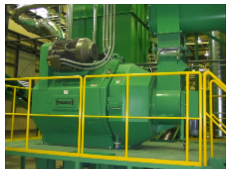
成形機 前処理された原料から RPF を製造します
