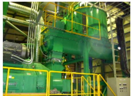
定量機 原料を定量供給します
